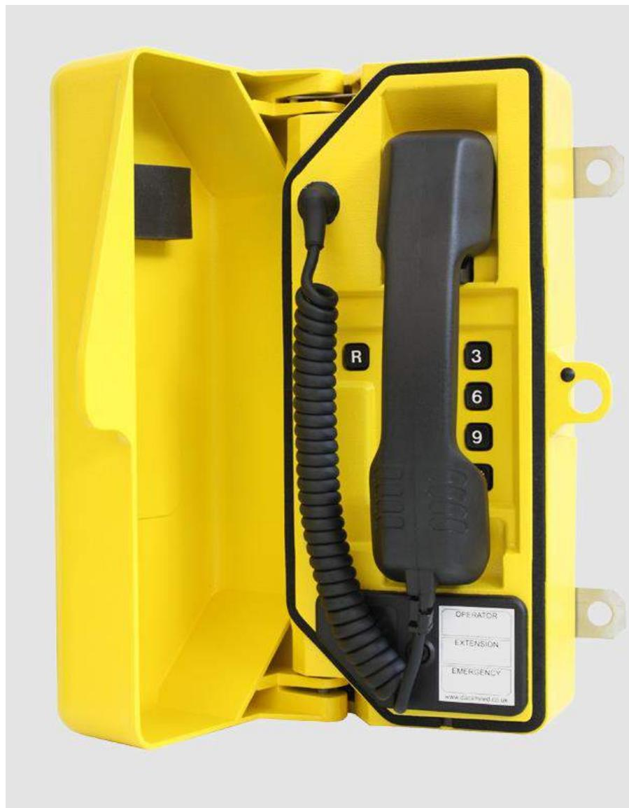
Ces téléphones sont entièrement contenus dans un boîtier en aluminium moulé résistant à la corrosion et aux intempéries avec une porte à fermeture automatique qui offre une protection complète contre la pénétration de la poussière et de l'humidité. Cela conduit à un produit extrêmement fiable avec une longue durée de vie.
