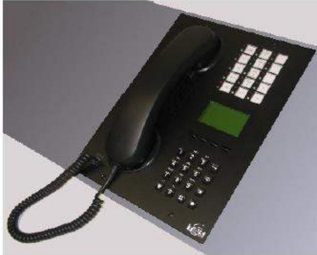
Le téléphone de bureau intégré FEP-IP4 avec écran est destiné à une utilisation directe sur un réseau local avec VoIP dans des environnements professionnels. Partout où les téléphones de bureau conventionnels ne peuvent pas être utilisés pour diverses raisons (ancrage, vol), le FEP-IP4 est le bon téléphone:
