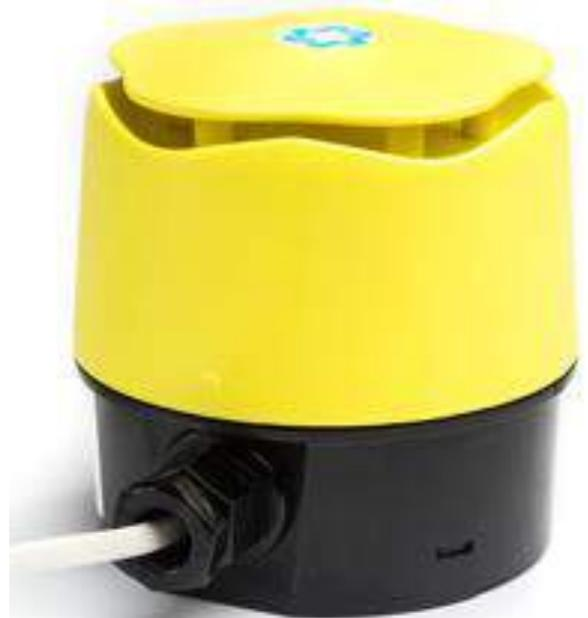
L'appelant Bedlam Loud Tone est conçu pour remplacer les cloches traditionnelles alimentées par le secteur et est alimenté par la tension de ligne PABX et PSTN (60-100VAC). Une puissance variable de 85-105dBA est obtenue au moyen d'un potentiomètre situé à l'intérieur de l'unité.
