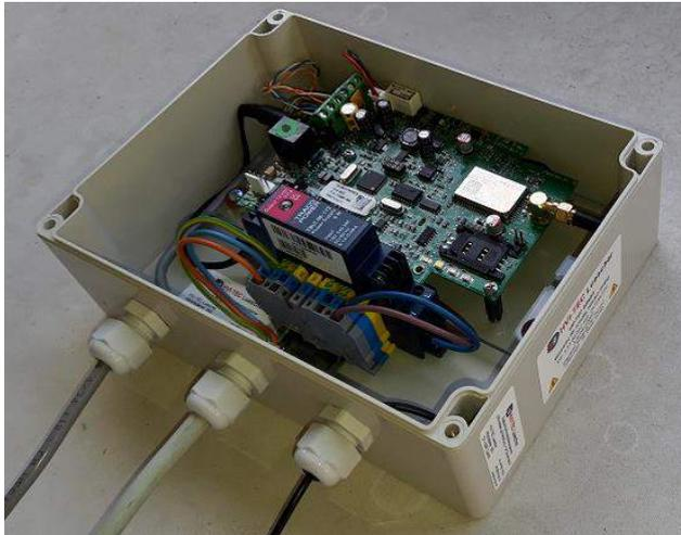
Simulation eines analogen Telefon Anschluss via 4G / LTE Mobilfunknetz sowie Möglichkeit der Datenübertragung.
